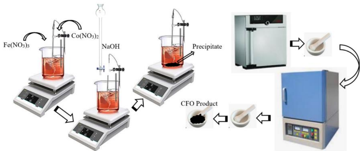
Gambar 2. Diagram skematik preparasi nanopartikel berbasis cobalt ferit
