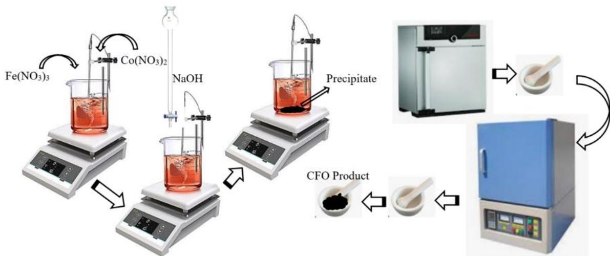
Gambar 2. Diagram skematik preparasi nanopartikel berbasis cobalt ferit
